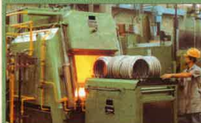
Fig. 19. Foto de Forno de Tratamento Térmico de Aço (Combustol)
